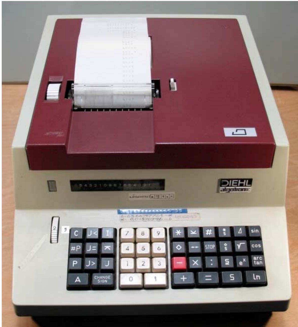
Diehl Algotronic, Tisch-Rechenmaschine, Baujahr 1971...74 mit 10 kBit Speicher und Metall-Bootlochstreifen
