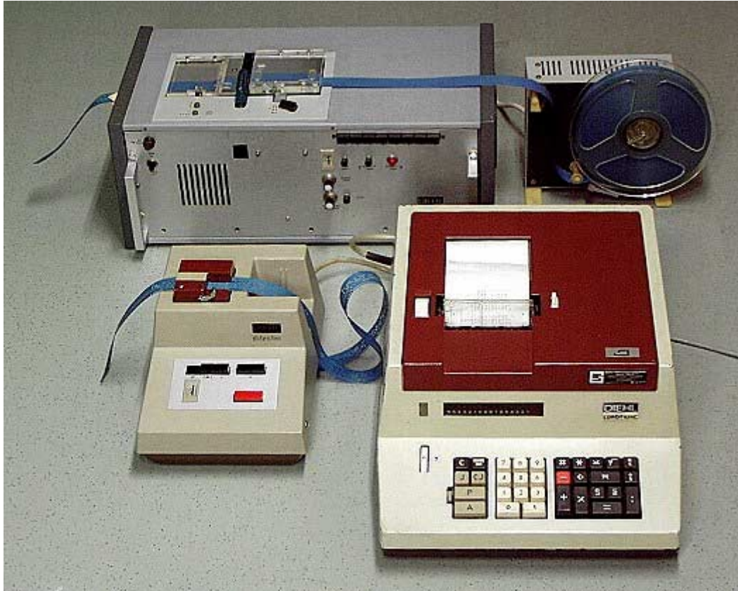
Im Hintergrund ist der dazugehörige Lochstreifenstanzer ELS 850 zu sehen und links der Lochstreifenleser „Dilector“.
